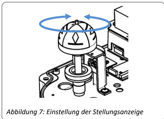
Unter einer transparenten Kuppel mit Viertelsegment-Abdeckung dreht sich eine zweifarbige Halbkugel als Stellungsanzeige.
