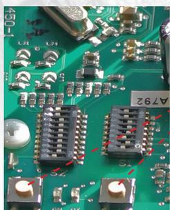
**Handbetätigung mit Taster und Parametriermöglichkeit mit DIP-Schalter**
